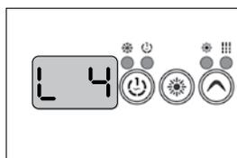
L'écran du clavier affichera alors **L xx**. « **xx** » correspond au numéro de configuration interne présentement utilisé par le système.
