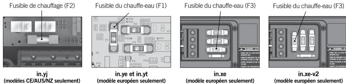
Pour les systèmes de contrôle européen, si la tension mesurée n'est pas conforme, remplacez le fusible du chauffe-eau.
