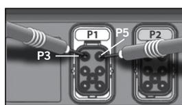
Mesurez la tension entre le connecteur P1 pins 2-3 (sortie pompe 1 haute vitesse 20A et 15A) et la pin 1 ou 5 (retour ligne 2 ou neutre), vous devriez mesurer :
