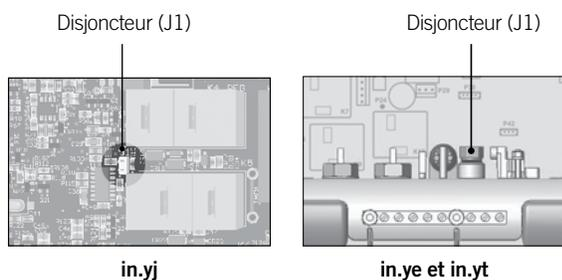
**Les systèmes de la série Y sont équipés d'un circuit qui déclenche le disjoncteur en cas d'erreur HL.**
