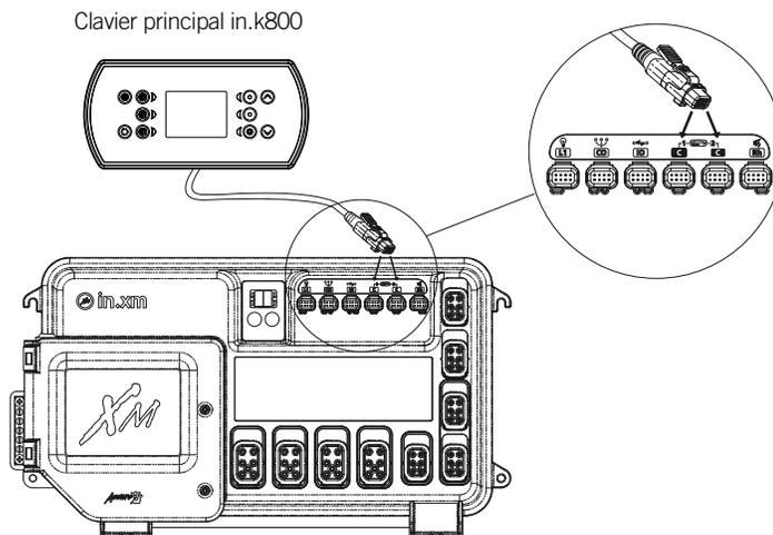
Pour raccorder le clavier in.k800, insérez simplement le connecteur in.link dans le connecteur de clavier approprié du boîtier du système de spa (comme illustré).
