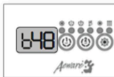
Les valeurs affichées par le système correspondent à 0,8 de l'intensité en ampères maximale du disjoncteur différentiel (RCD).
