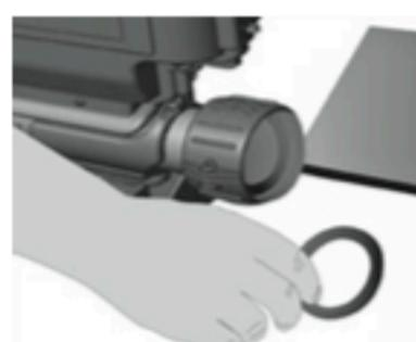
Placez un joint torique en caoutchouc de 50 mm (2 po) à chaque extrémité des écrous du chauffe-eau pour prévenir les infiltrations d'eau entre les écrous et les pièces de raccordement en PVC.
