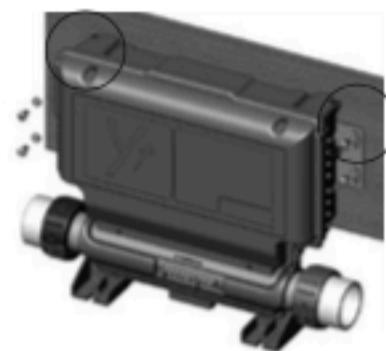
Installez les supports de fixation des deux côtés, à l'arrière du bloc, à l'aide des vis fournies avec le support.
